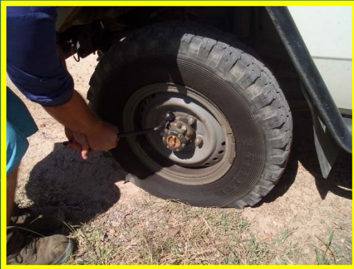
Slacken Wheel Nuts
